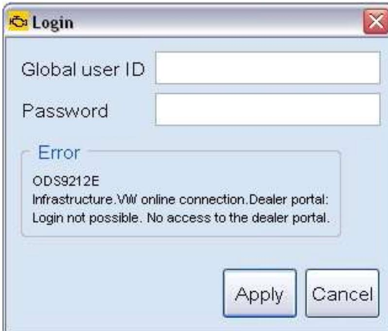
Figure 6.23. Impossible de se connecter aux systèmes du Groupe
