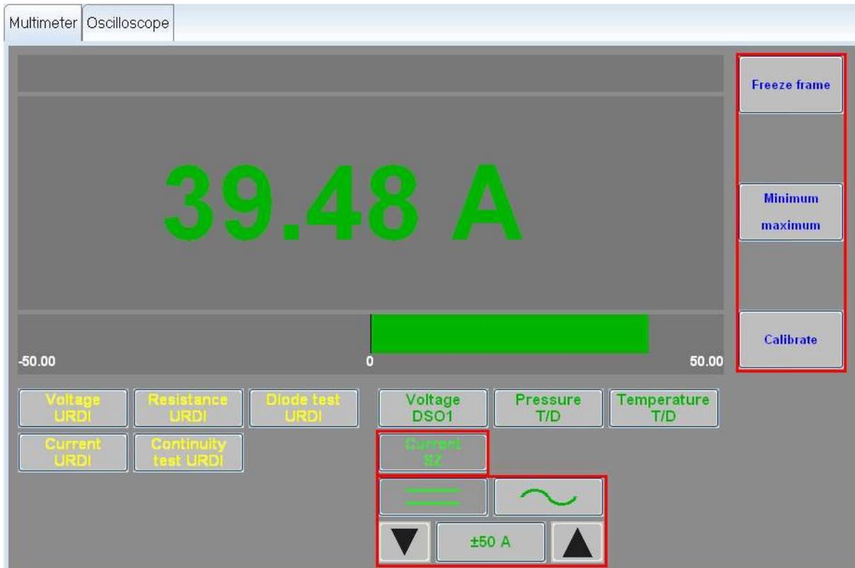
Figure 9.11. Volet client avec mesure de l'intensité « Intensité Pince ampèremétrique » activée
