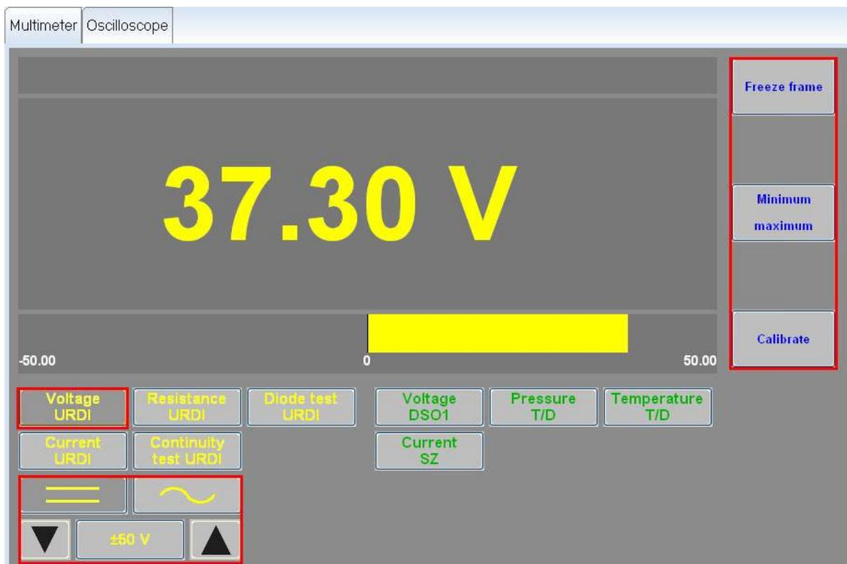
Figure 9.5. Volet client avec mesure de la « Tension URDI » activée
