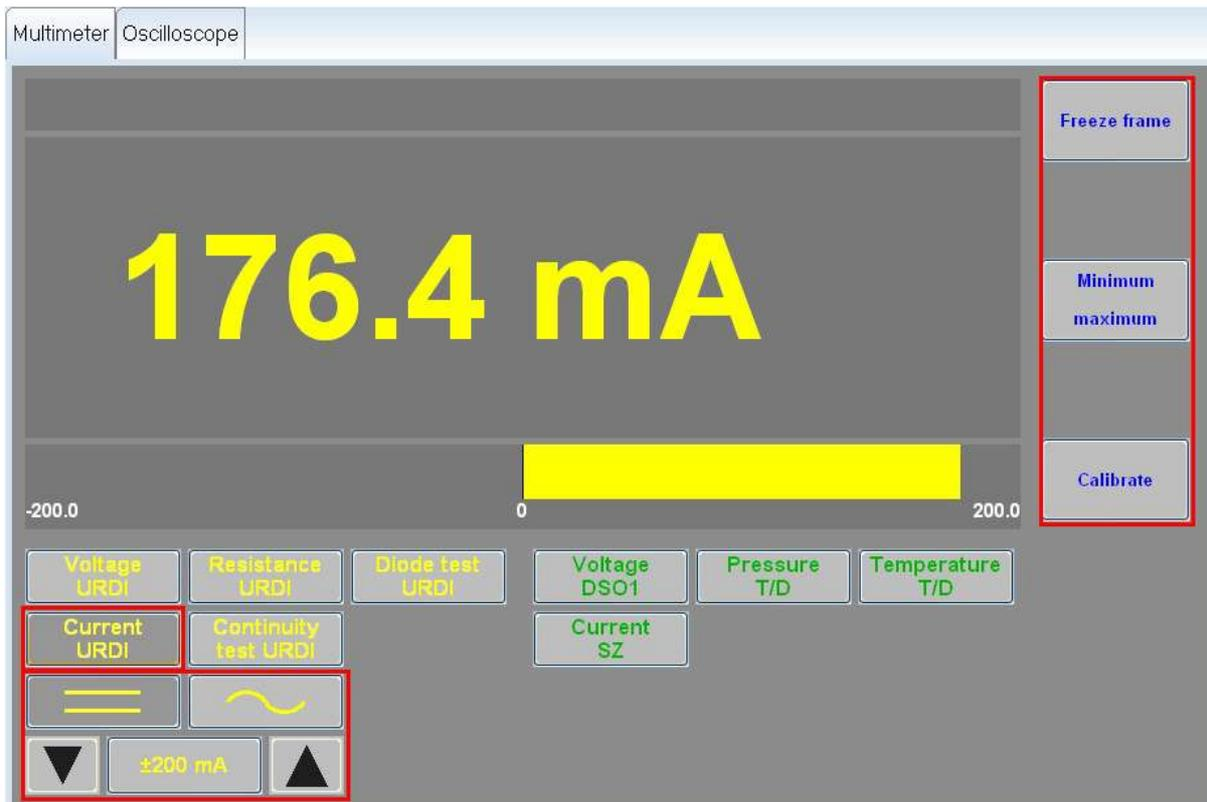
Figure 9.6. Volet client avec mesure de l'intensité « Intensité URDI » activée
