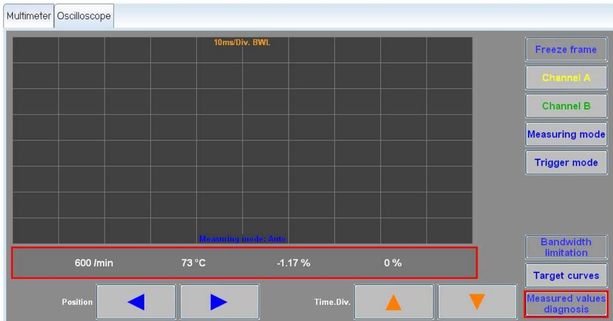
Figure 9.25. Affichage des valeurs de mesure de diagnostic sur le multimètre
